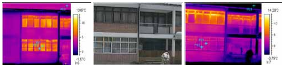
Слика 22 Термографска претстава на реконструирани прозорци (десна страна по реконструкција)
